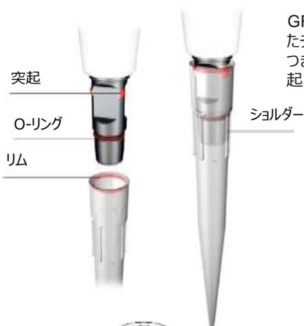
GRIPTIPS®および EVOLVE, VIAFLO, VOYAGER のノズルの特殊構造により、ノズルに装着されたチップがロックされます。ピペット操作中にピペットからチップが落下したり、精度エラーの原因となるグラつきが起きません。また、毎回同じ位置（深さ）に装着されますので、チップの装着度合いの違いで起こる精度エラーも防ぎます。
