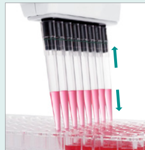
Pipetage/Mélange Transfert d'un volume défini suivi d'un nombre défini de cycles de mélange automatique
