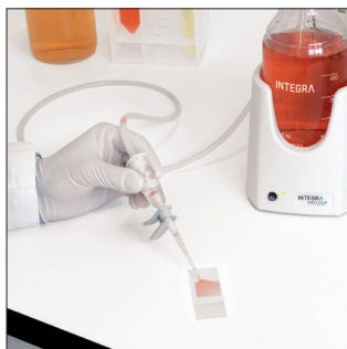
顕微鏡スライドの余分な液体を除去
